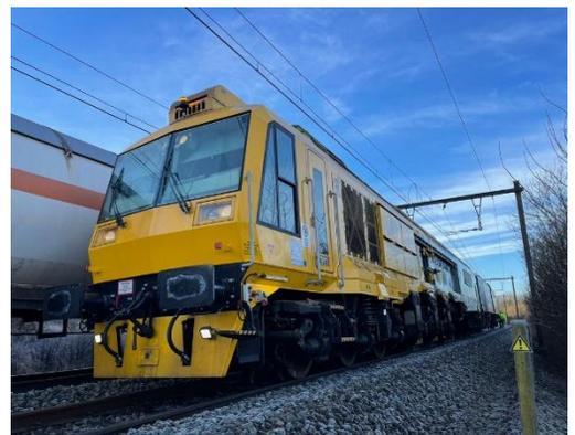
Gleisfräsmaschine der RCS Milling. Quelle: s-milling Technologies
