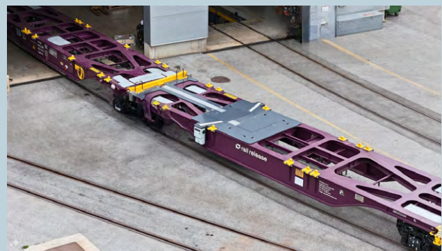
Der neue «Power Wagon» von Railrelease mit einer Batterie in Unterflurkonfiguration
